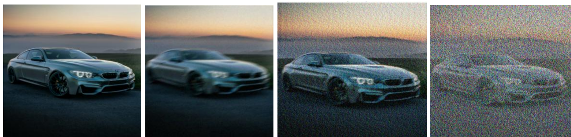
Рис.2. Зміна якості зображення а-оригінальне; б- піддане складній деградації, та відновлене інверсною фільтрацією при малих (в) і високих шумах (г).
