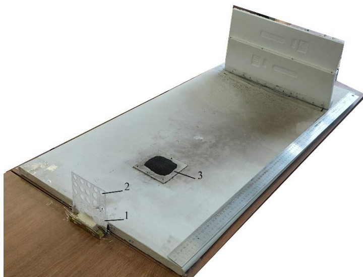
Рис. 1. Фото експериментальної установки (напівпроникний бар'єр, перфорація зверху): 1 – частина бар'єру без перфорації; 2 – частина бар'єру з перфорацією
