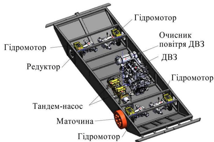
Рис. 9. Компоновка силової установки і гідравлічних агрегатів в бортовій трансмісії всюдихода Tornado з аксіальнопоршневими гідромотор-колесами
