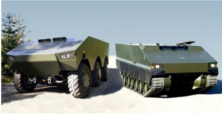
Рисунок 8 – Машина SEP APC з гібридною електромеханічною трансмісією, з колісною формулою 8×8 та гусеничною та колісною ходовою частинами (а) та силова установка на двох двигунах з електричною передачею (б)
