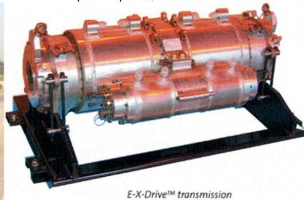
Рисунок 9 - Платформи FCS-T та FCS-W з гібридним електричним приводом (а) та гусенична електротрансмісія FCS-T (б)
