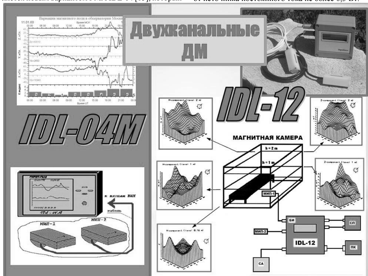
Рис.3. Двухканальные феррозондовые ДМ - IDL-04M (слева), IDL-12 (справа) и фрагмент применения ДДМ при проведении исследований в МК.
