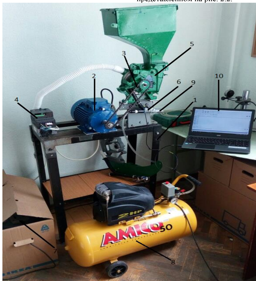
Рис. 2.2 - Стенд для исследований пневматических высевальных аппаратов
