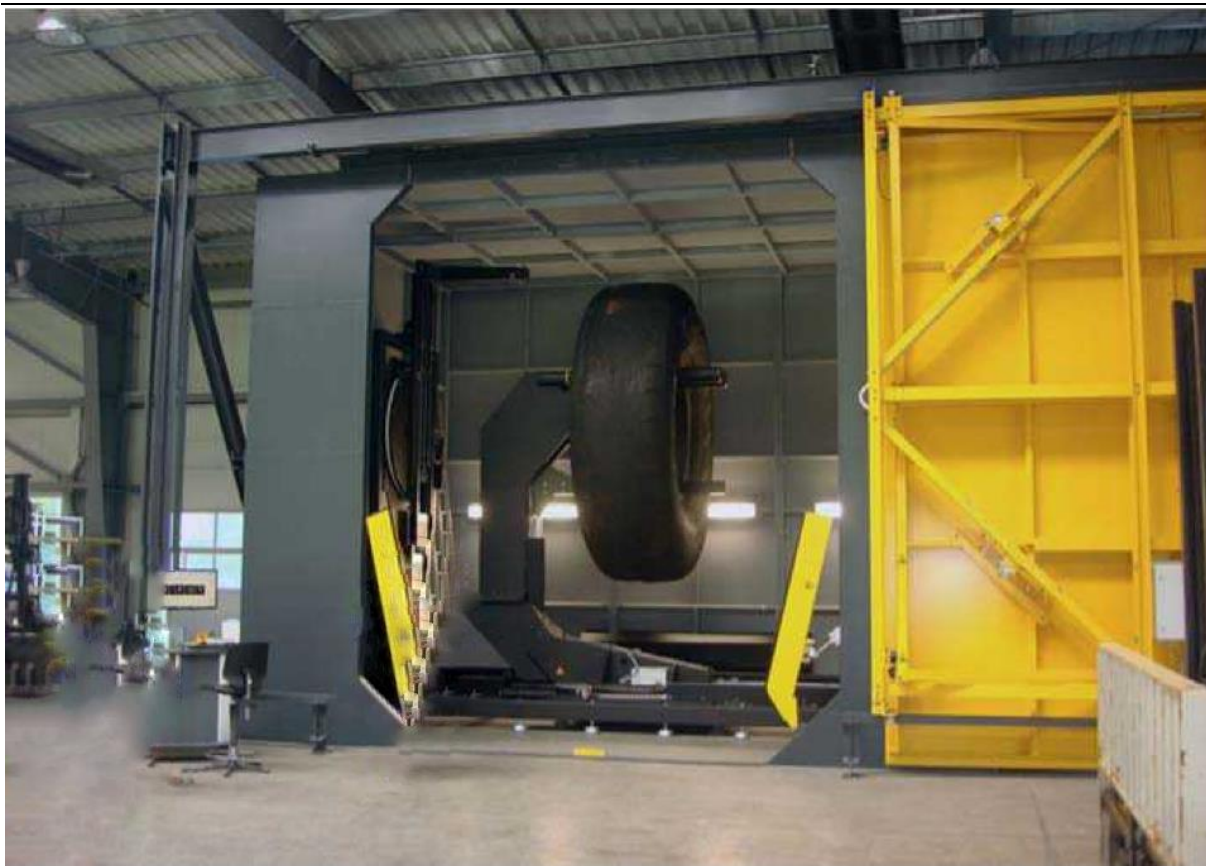
Рисунок 5. Установка для вакуумной ширографии КГШ и СКГШ с посадочным диаметром до 63" производства фирмы "Steinbichler" (Германия), модель "Intact 4300-3" в Поволжской шинной компании.
