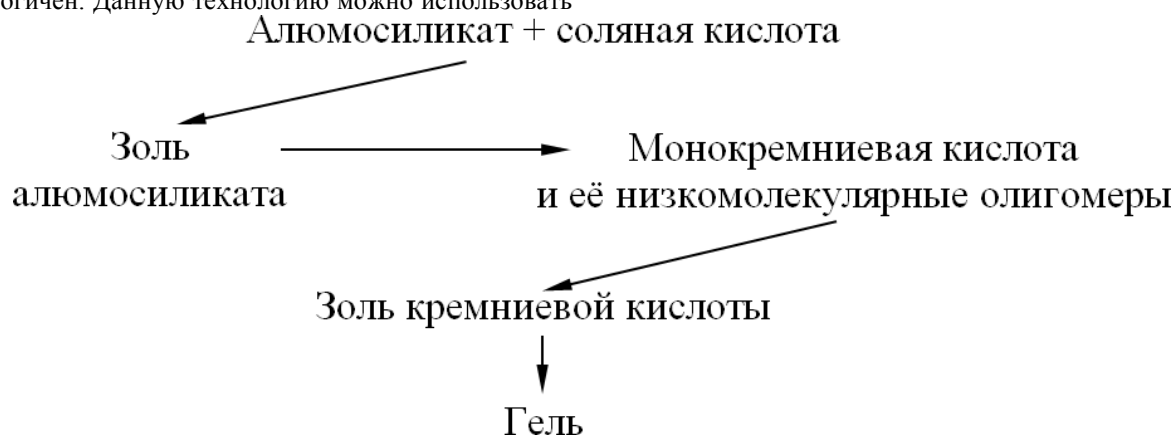
Рисунок 1.1 – Схема реакции гелеобразования
